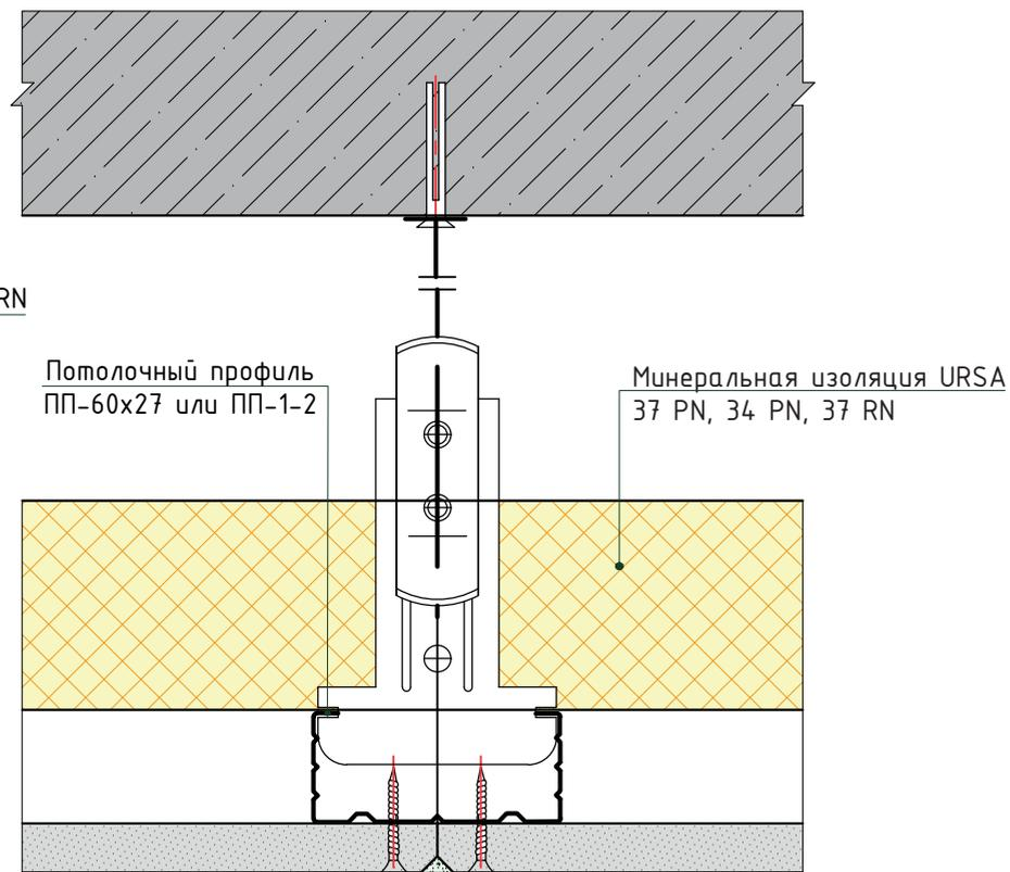
Устройство потолка на анкерном подвесе. АП-2 или АП-1. Сечения В-В, Г-Г
