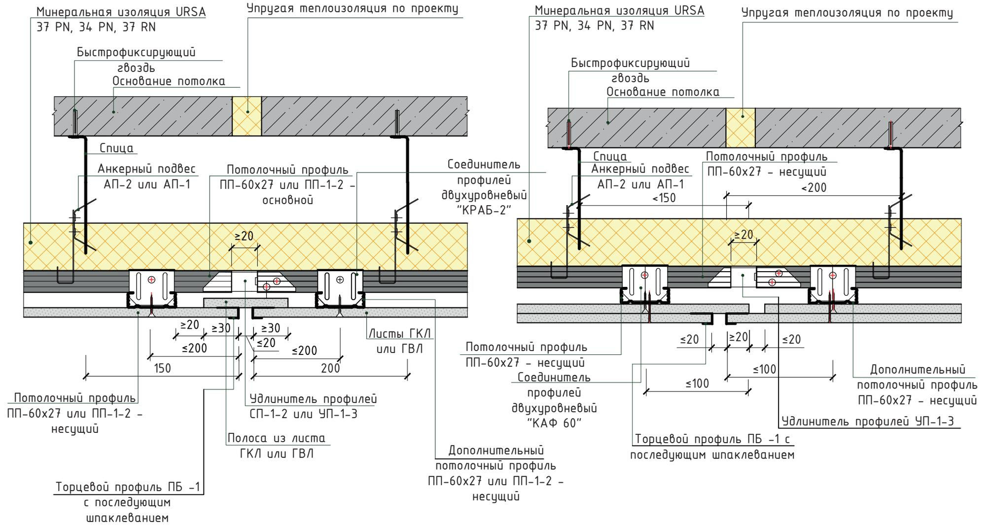
Температурный (деформационный) шов в местах деформационного шва здания или через 15 м потолка.
