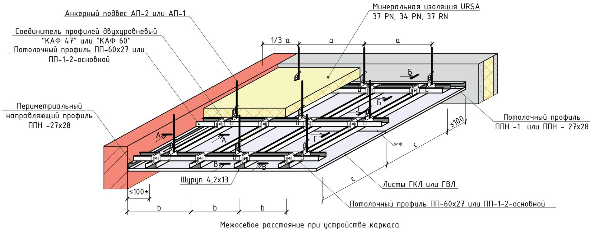
Межосевое расстояние при устройстве каркаса
