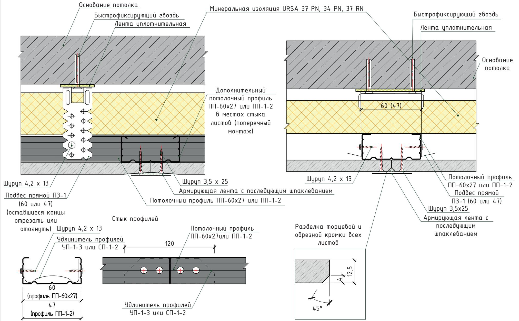
Устройство потолка на прямом подвесе ПЗ-1. Сечения В-В, Г-Г
