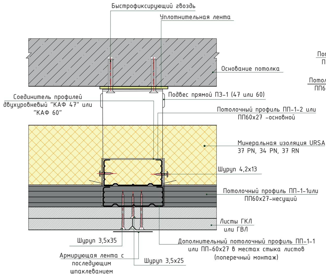
Пример соединения профилей ПП60x27 соединителем "КАФ 60"
