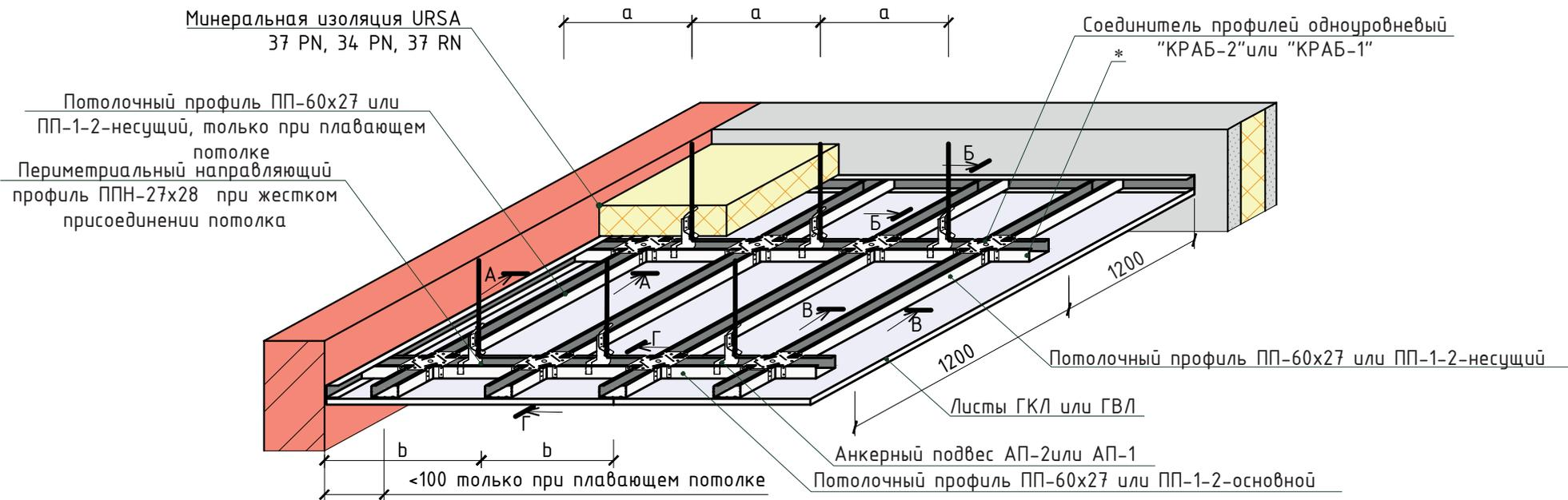
Межосевое расстояние при устройстве каркаса
