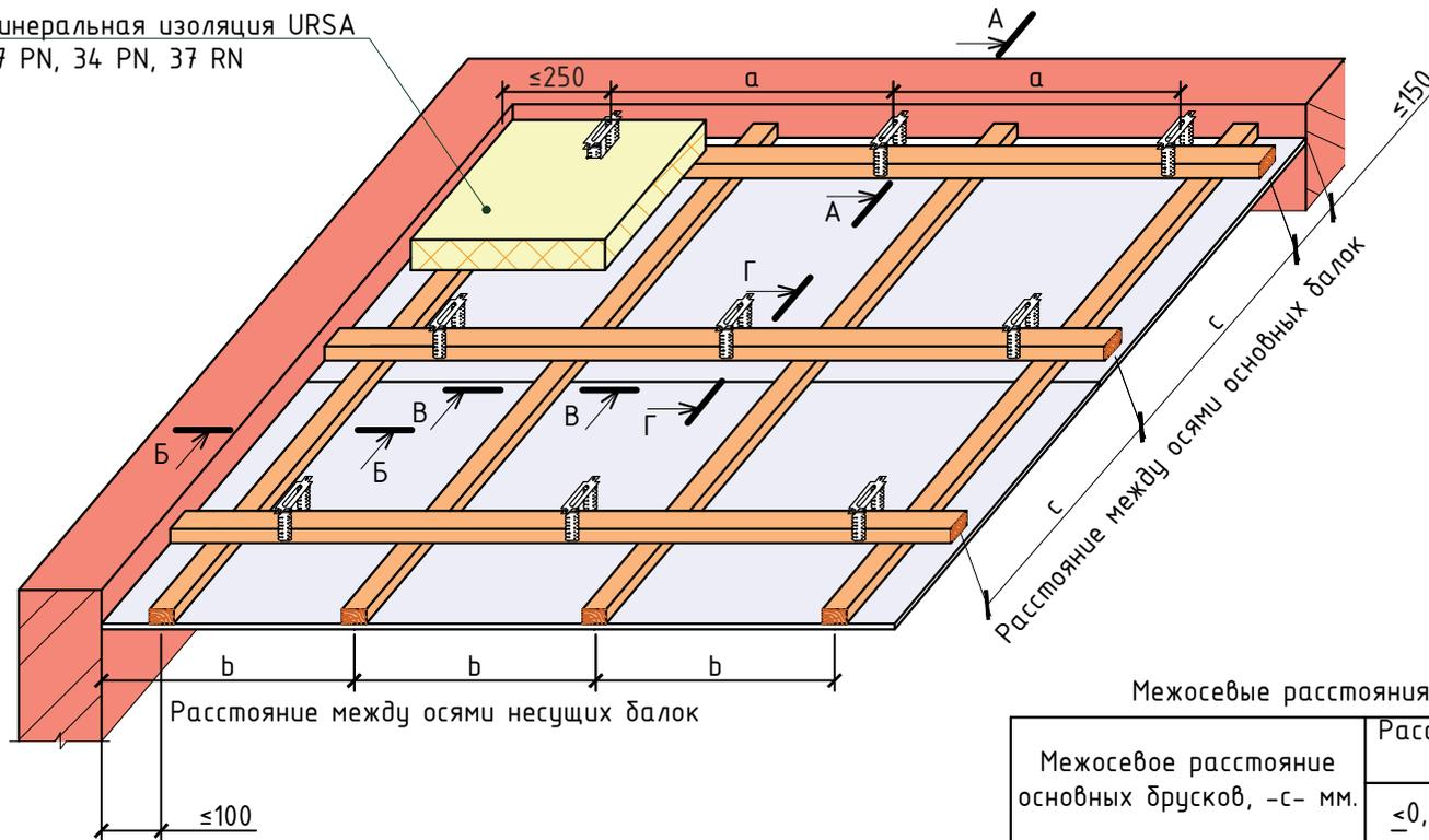
Межосевые расстояния при устройстве каркаса
