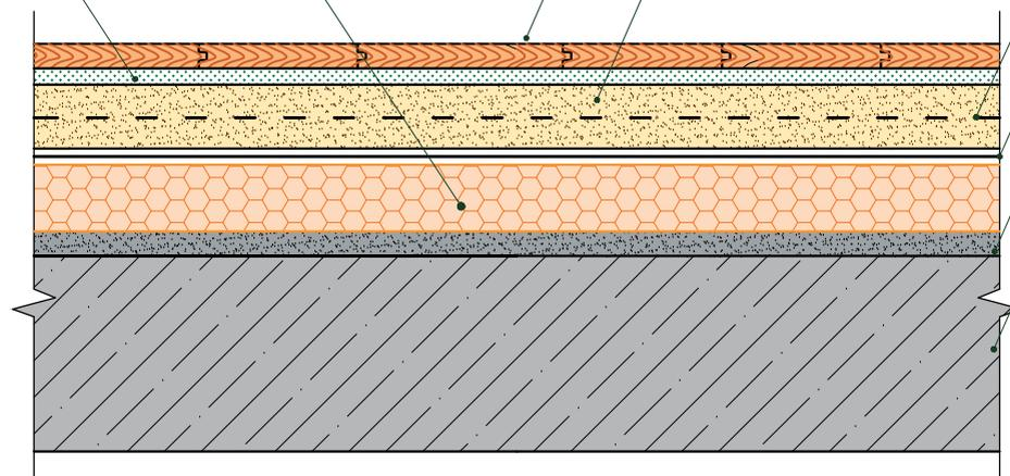
2) Полы по грунту на столбиках при холодном подполье на бетонном основании
