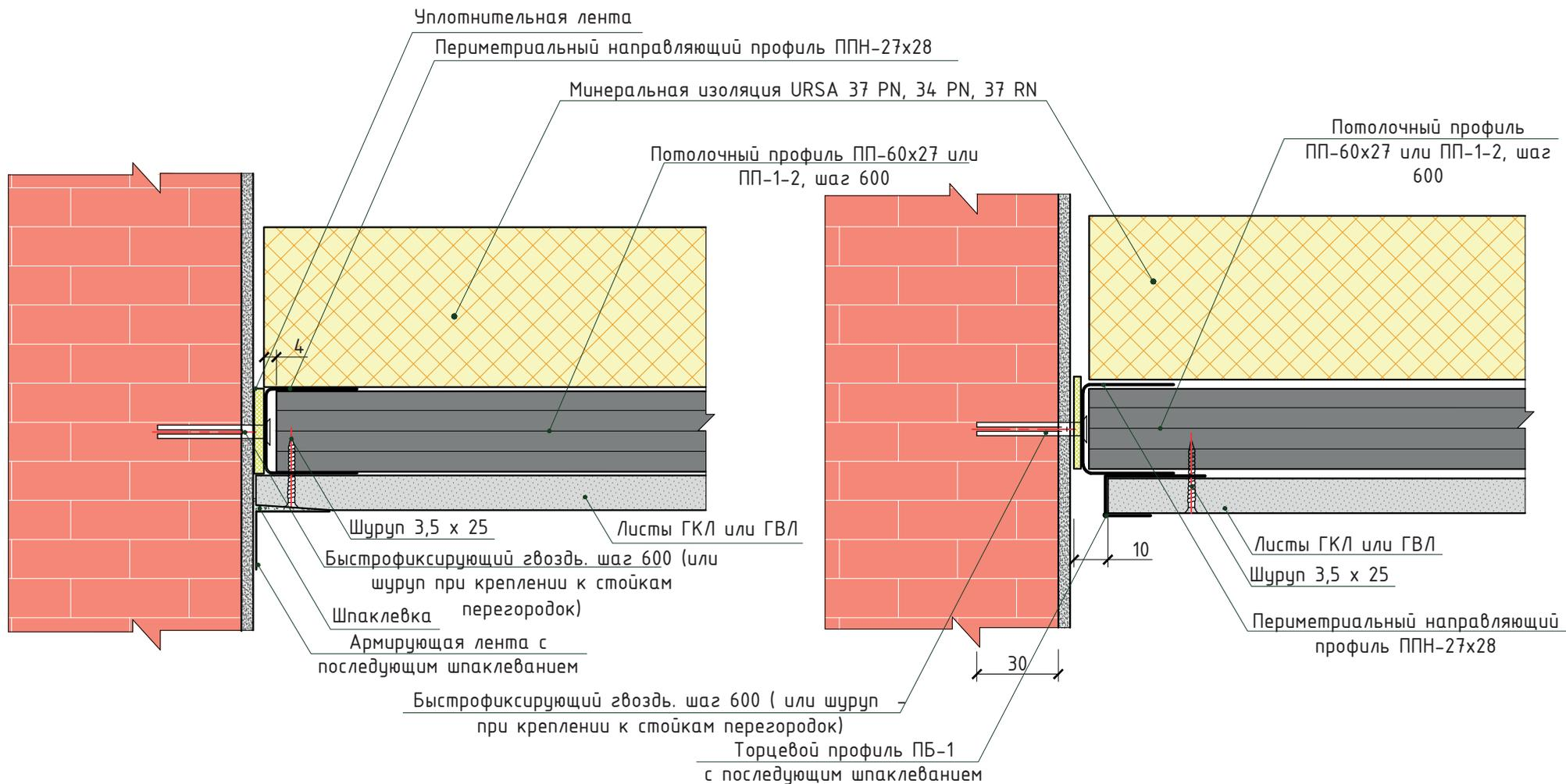
Сечение Б-Б. Жесткое присоединение потолка
