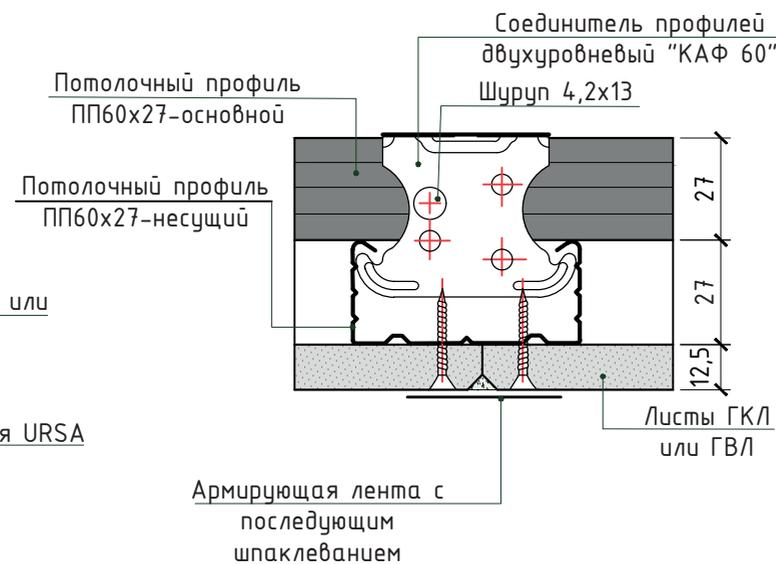
Сечение Г-Г. Пример соединения профилей ПП60x27 соединителем "КАФ 60"
