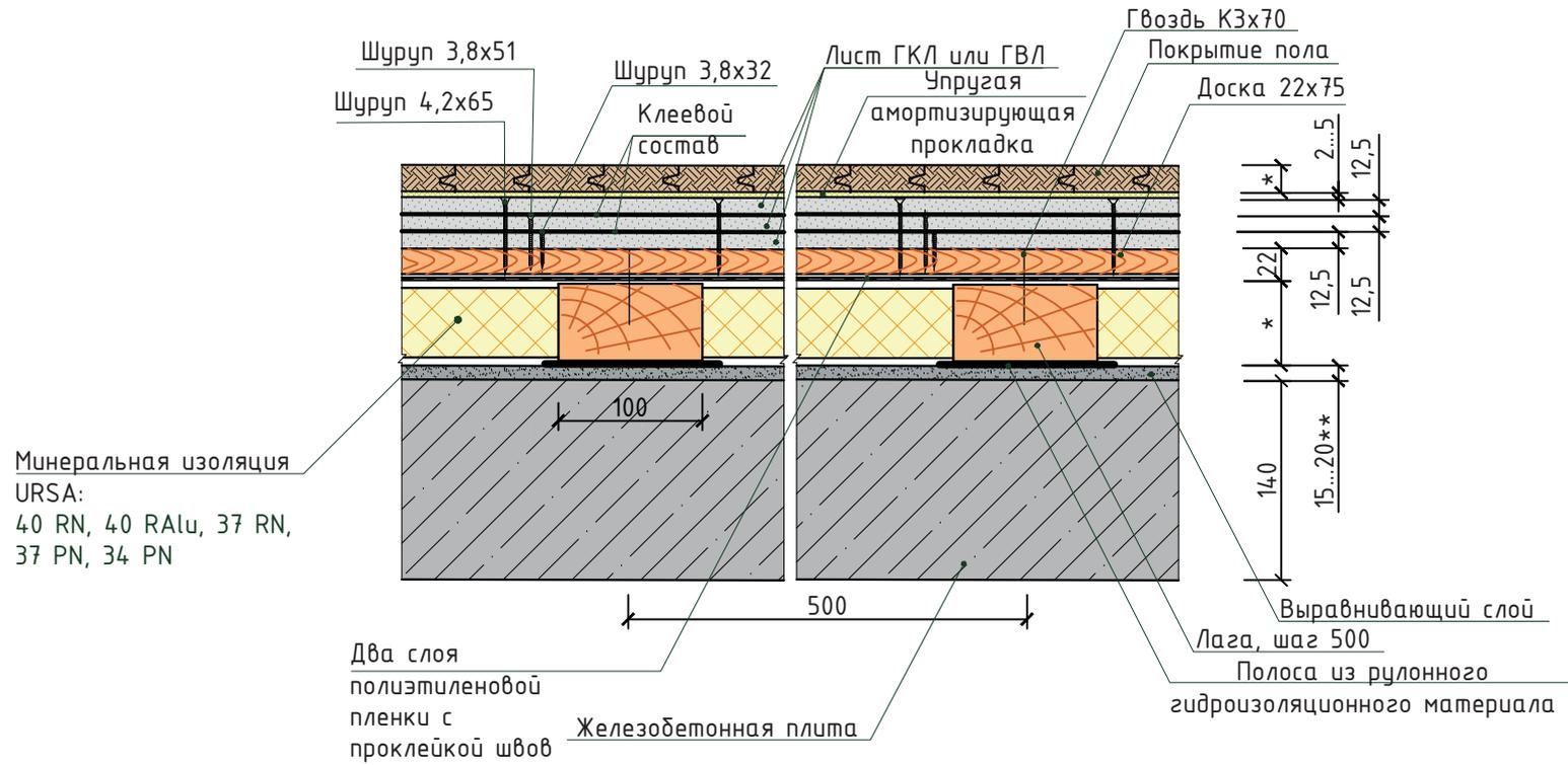
4 Полы по железобетонному перекрытию
