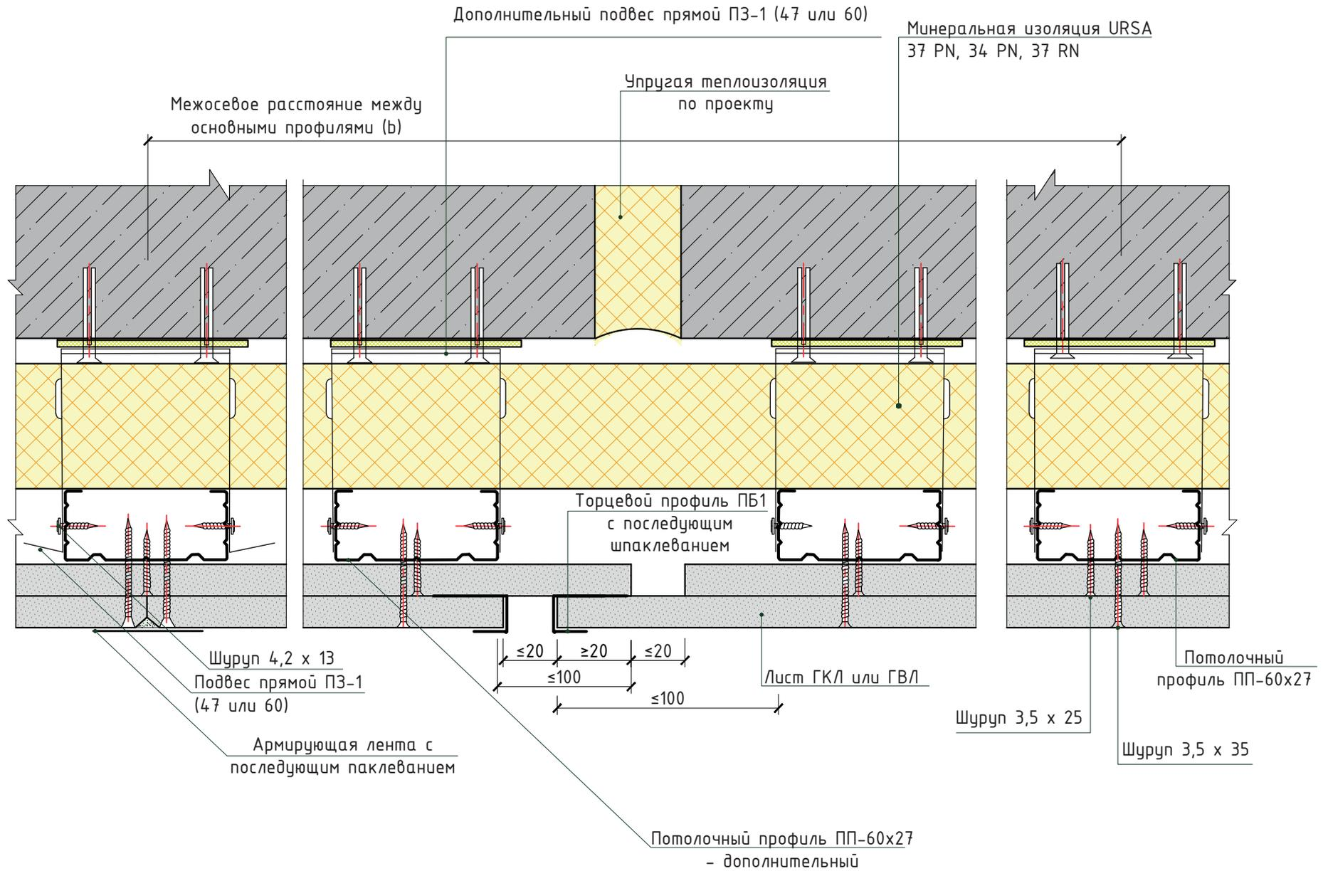
Температурный (деформационный) шов в местах устройства деформационного шва здания или через 15 м потолка.
