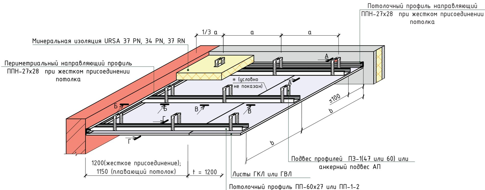
Межосевое расстояние при устройстве каркаса
