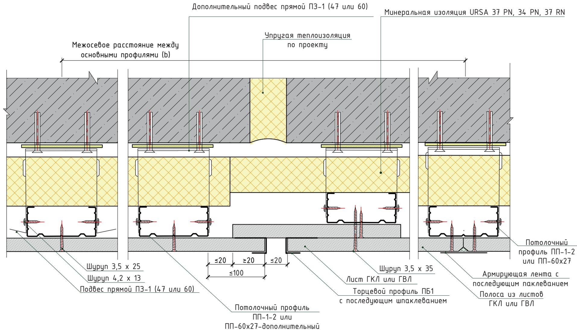
Температурный (деформационный) шов в местах устройства деформационного шва здания или через 15 м потолка.
